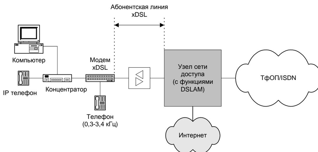
**Рисунок 2** Разделение трафиков на уровне сети доступа<sup>3</sup>
